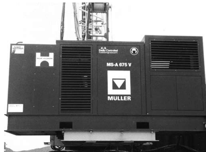
Рис. 39. Общий вид гидравлической станции привода вибропогружателя
