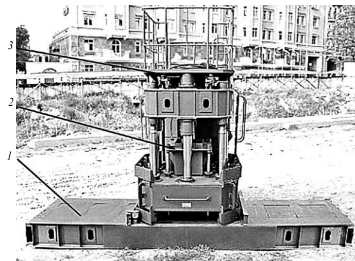
Рис. 23. Установка вдавливания свай CO 450: 1 – грузовая рама (при вдавливании свай на плечи с двух сторон укладываются инвентарные металлические грузы массой по 5 т); 2 – гидроцилиндры; 3 – рабочая площадка с ограждением
