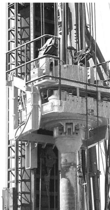
Рис. 41. Общий вид вращателя (ротора) и мачты установки, рабочей площадки бетонщика
