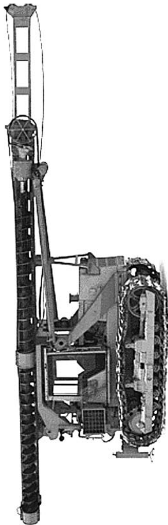
Рис. 5. Общий вид самоходной бурильно-свабойной машины БМ 833
