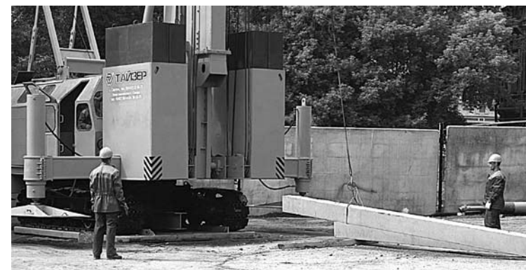
Рис. 12. Общий вид установки СВУ В-6
