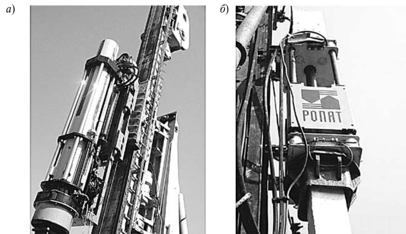
Рис. 10. Общий вид гидравлических молотов: а – молот установлен на мачте универсального копра; б – то же на мачте копра на базе трактора
