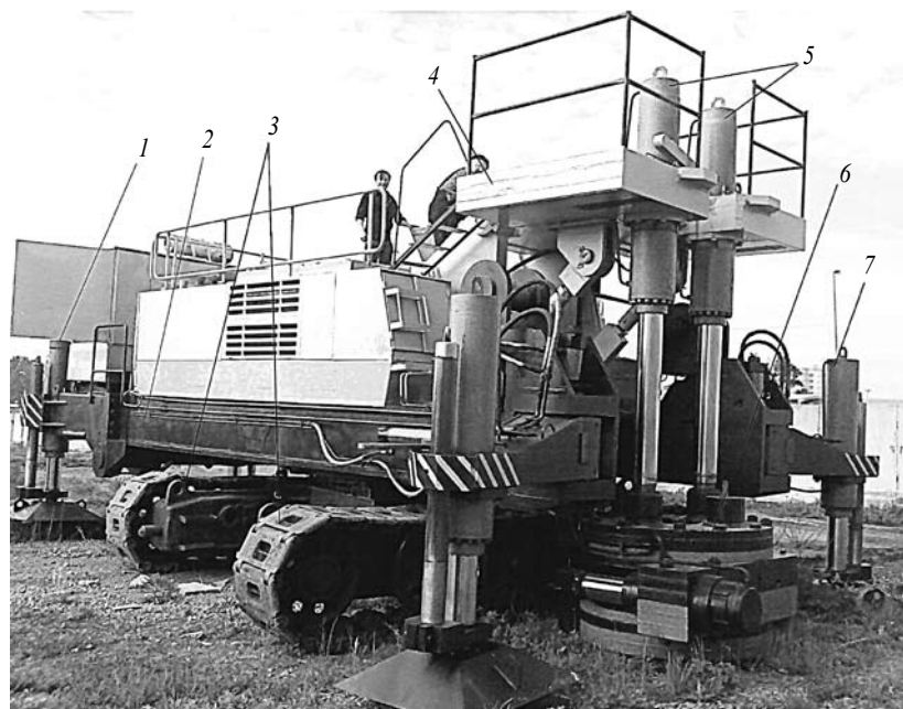
Рис. 21. Установка вдавливания свай УСВ 160: 1, 7 – задний и передний аутригер; 2 – сварная несущая рама; 3 – гусеничная тележка экскаватора ЭО 6122; 4 – площадка для копровщика при наведении сваи и выполнении стыка составных свай; 5 – гидроцилиндры перемещения зажимного устройства; 6 – зажимное устройство
